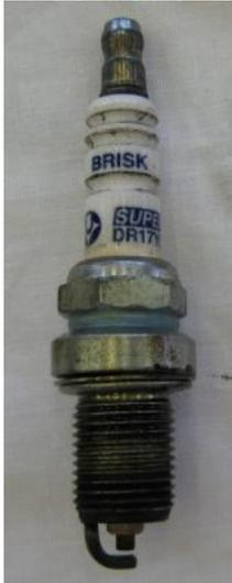
Внедрение индивидуальных катушек зажигания обусловило применение свечей зажигания с уменьшенным размером шестигранника под ключ (S16).
