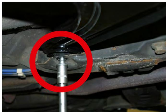
**12** Затяните крепежные болты с крутящим моментом, предусмотренным изготовителем транспортного средства.
