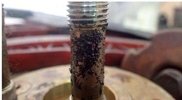
*Начальная стадия загрязнения фильтра масляного канала на фазорегуляторе автомобиля БМВ. В конечной стадии довольно часто дает возможность сервисам очень не плохо подзаботиться на смене элементов цепного механизма ГРМ*
