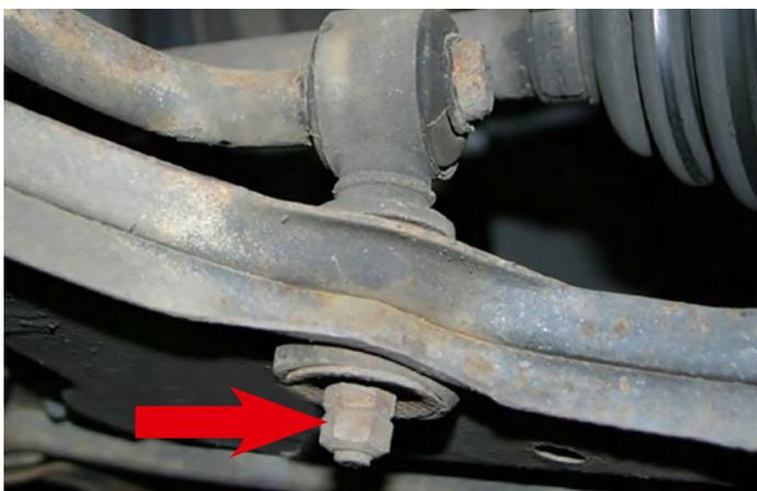
**11** Теперь опустите автомобиль, пока подвеска не будет сжата. Здесь выгодно использовать четырехстоечный подъемник.
