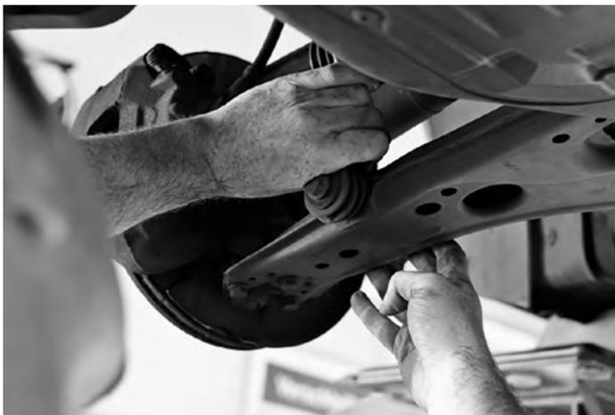
**4** Если стабилизатор подключен к рычагу управления, следующим шагом будет ослабление и удаление соответствующих крепежных болтов стабилизатора.
