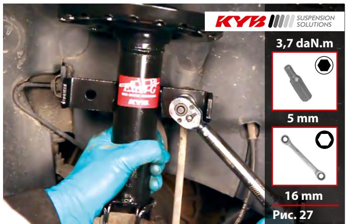
Для облегчения сборки нижнего крепления амортизатора снова используем домкрат. Здесь важно не допустить перекоса.
