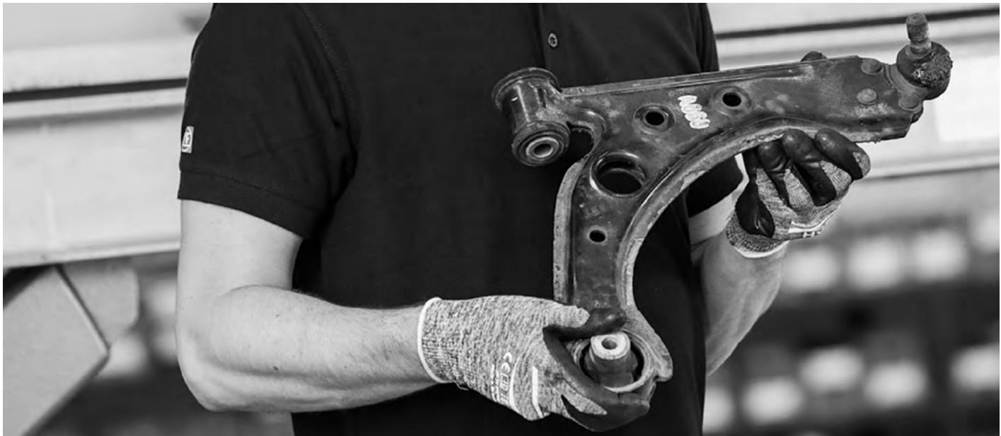
Рычаги подвески устанавливаются парами на передней и задней оси. Они соединяют шасси с колесами как часть подвески. Поэтому они оказывают существенное влияние на движущие характеристики транспортного средства.
