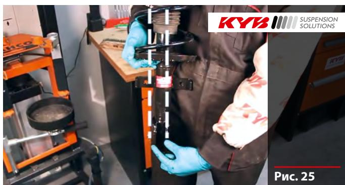
Сборку проводим не в обратном порядке, а начиная с нижнего крепления. Не забываем использовать динамометрический ключ для соблюдения требуемого усилия затяжки. Важно помнить, что верхнее крепление амортизатора на этом этапе мы не затягиваем, а только наживляем.
