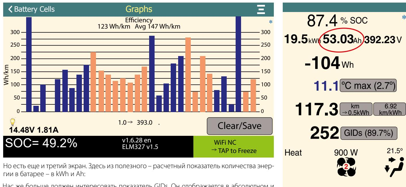
Но есть еще и третий экран. Здесь из полезного – расчетный показатель количества энергии в батарее – в kWh и Ah:
