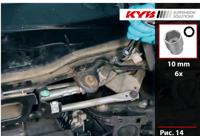
И только теперь можно добраться до верхнего крепления амортизаторной стойки.
