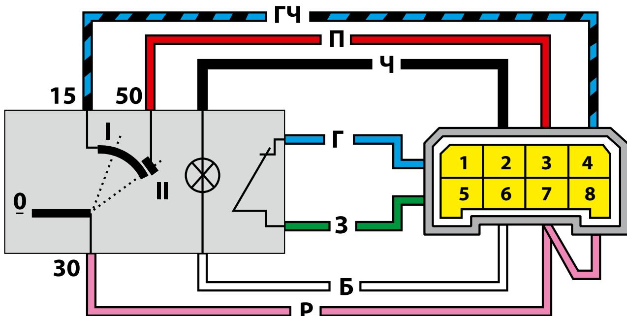
Схема 3. Распиновка замка зажигания: 1) приходит + 12В для микрика датчика вставленного ключа
