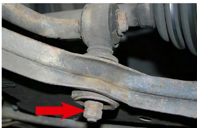
**5** Ослабьте и снимите крепежные болты рычага управления.
