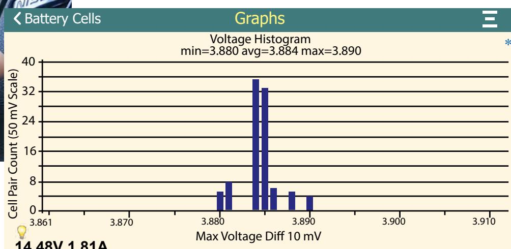
На нем можно увидеть какие ячейки имеют то или иное напряжение. Таким образом, мы понимаем насколько батарея сбалансирована. В идеале мы должны получить всего одну риску максимальной величины.
