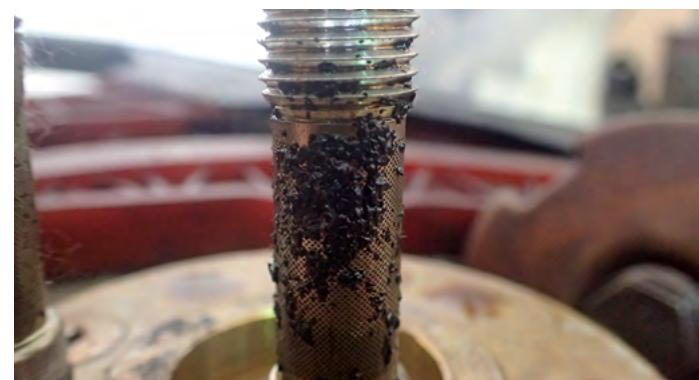
Начальная стадия загрязнения фильтра масляного канала на фазорегуляторе автомобиля БМВ. В конечной стадии довольно часто дает возможность сервисам очень не плохо подзаработать на смене элементов цепного механизма ГРМ
