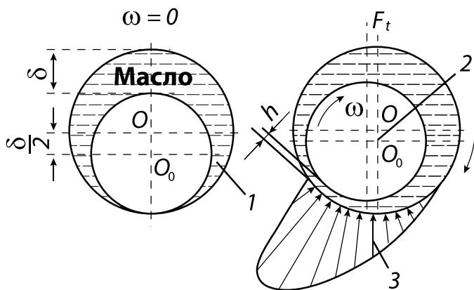
При вращении цапфа 2 увлекает масло 1. В образовавшемся масляном клине создается избыточное давление, обеспечивающее разделение цапфы и подшипника слоем масла. 3 — элюра распределения гидродинамического давления в масляном клине.
