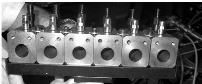
Фото 3. Набор адаптеров для тестирования грузовых Common Rail форсунок.
