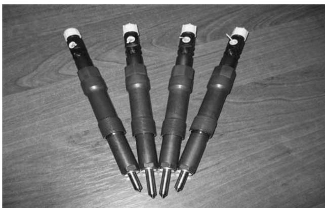
Фото 26. Форсунки Common Rail фирмы Delphi, устанавливаемые на автомобили Ford Transit, Ford Connect.
