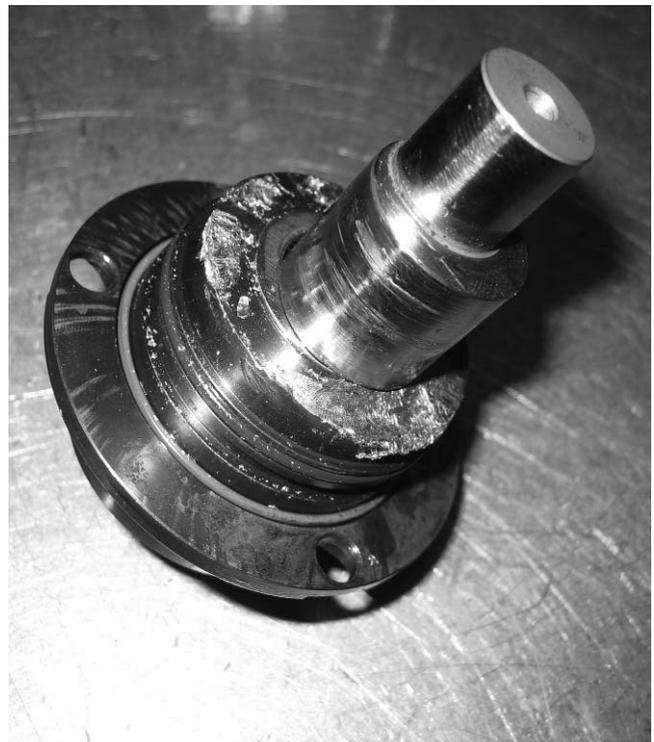
Фото 31, 32, 33. Разрушенный из-за попадания воды и грязи Common Rail насос Mercedes Sprinter CDI. На фото 32 и 33 - его детали: корпус и вал.
