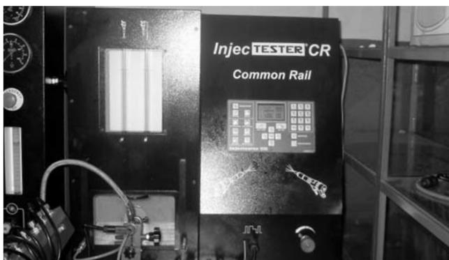
Фото 4. Стенд InjecTester Common Rail спроектирован для проверки классических, двухпружинных и Common Rail форсунок всех 4 мировых производителей - Bosch, Denso, Delphi и Siemens.
