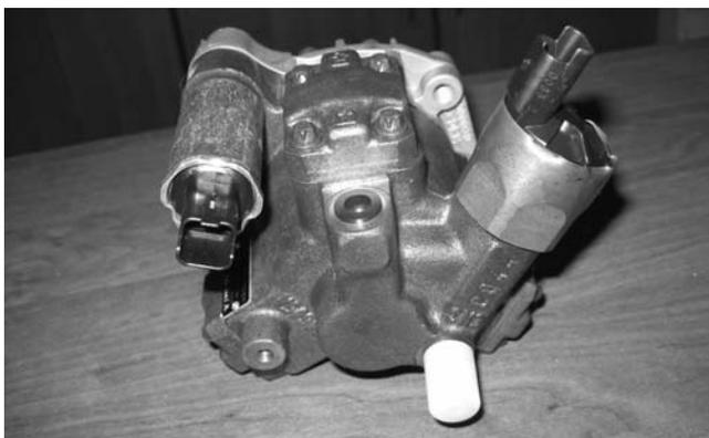
Фото 30. Common Rail насос фирмы Siemens.
