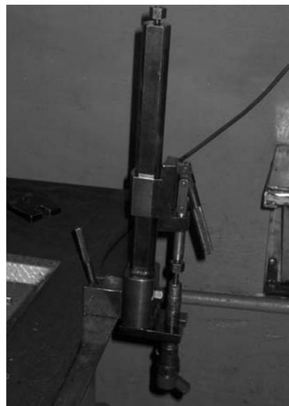
Фото 12, 13, 14. Станция для разборки Common Rail форсунок. Дефектовка деталей производится визуально, в случае необходимости - с помощью микрометра или под микроскопом, позволяющим сканировать изображение на монитор компьютера.
