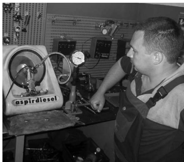
Фото 11. Первичная диагностика форсунок Common Rail при помощи модулятора сигналов и обычного форсуночного стенда. Проверяется качество распыла и гидроплотность форсунки, что позволяет не тратить время на установку заведомо неисправной форсунки на специальные стенды.
