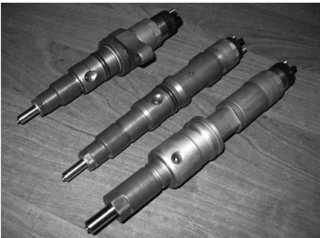
Фото 24. Форсунки Bosch для двигателей грузовиков некоторых моделей Iveco, MAN, и Renault Premium.
