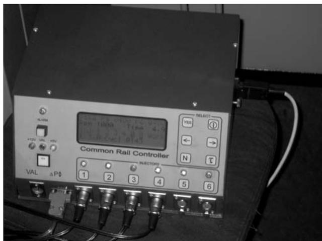
Фото 6. Common Rail Controller для тестирования Common Rail насосов и форсунок на стендах для классических ТНВД. Цифровое табло показывает выбранный оператором режим: давление в аккумуляторе топлива, длительность срабатывания каждой форсунки в миллисекундах, количество циклов срабатывания, и количество подключенных к стенду форсунок.
