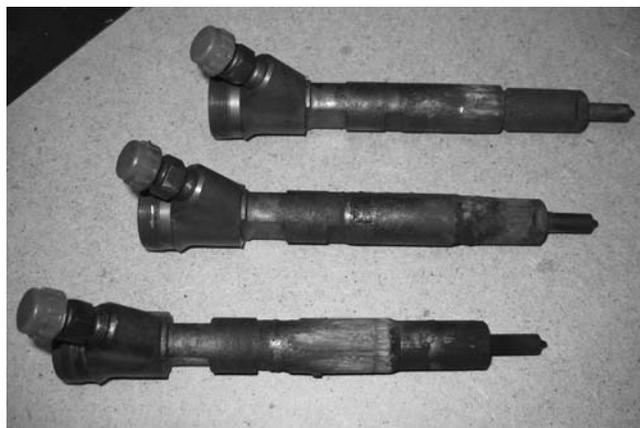
Фото 16, 17. Форсунки Common Rail, извлеченные из двигателя автомобиля Мерседес с помощью 15-тонного гидросъемника. Обычными средствами извлечь их было невозможно. Также видны следы сваривания стали форсунок с алюминием головки блока.
