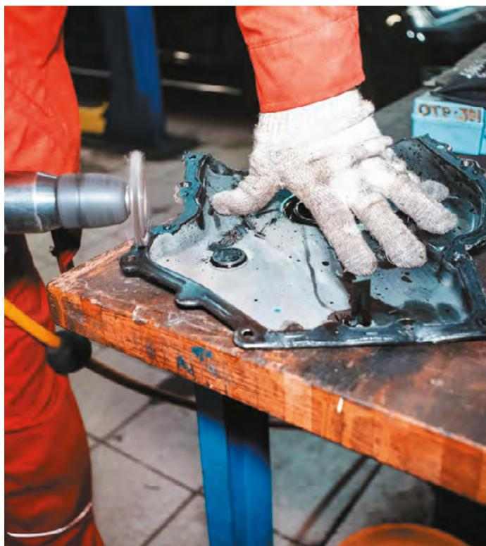
*Очищаем крышки и наносим новый герметик на привалочные поверхности*
