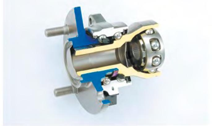
двумя фланцами типа HUB-III, в который встроен ШРУС (CVJ).
