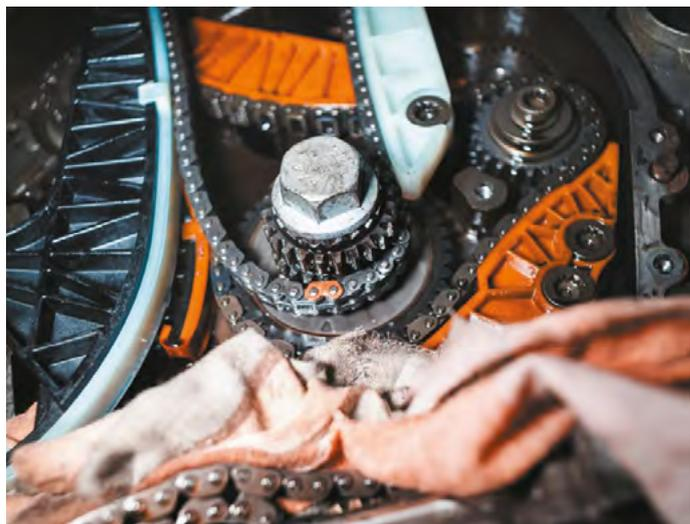
Чтоб совместить все три метки, нужно использовать специнструмент, опыт, недюжинное терпение и спокойствие. Метки цепи ГРМ и звёзд совмещены, надеваем успокоитель.
