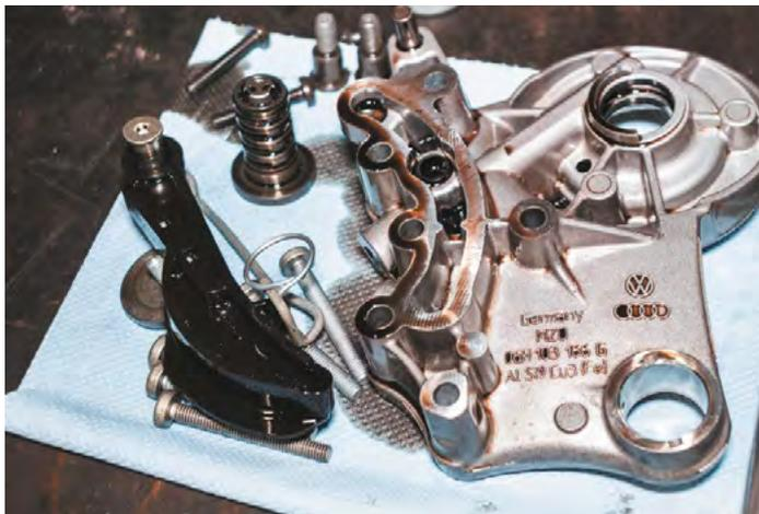
*Опора распредвалов Фольксваген Тигуан ждёт очистки и обратной установки*
