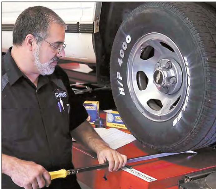
*Износ осевого шарового шарнира может быть первоначально проверен с помощью монтажной монтировки. Качая колесо, визуально проверьте люфт в шарнире*
