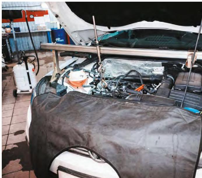
*Замена цепи ГРМ Фольксваген Тигуан продвигается. Вывешиваем двигатель Фольксваген Тигуан на траверсе*
