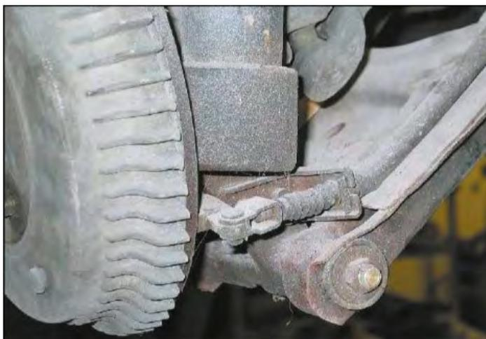
*Внутренние и внешние сайлентблоки управления должны быть проверены на износ резины, трещины и на чрезмерное движение*
