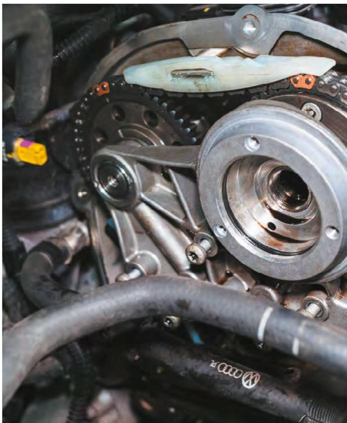
*Возвращаем корпус привода ГРМ на место*
