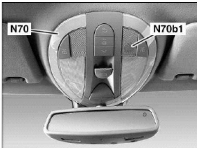
Потолочная панель управления посылает данные о температуре воздуха в салоне на блок управления (N22; N22/7).
