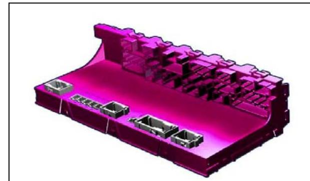
Отслеживает дверной контакт и контакт люка. Следит за напряжением обогрева заднего стекла.
