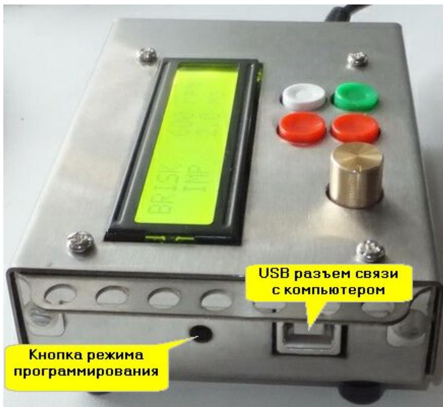
При входе в режим программирования надписи на индикаторе имитатора исчезают. В программе DfuSe\_Demo должна быть такая картинка:
