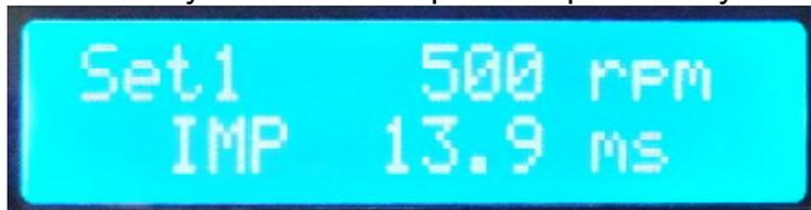
Установка параметров измерительного резистора (нажатие белой кнопки в состоянии СТОП)
