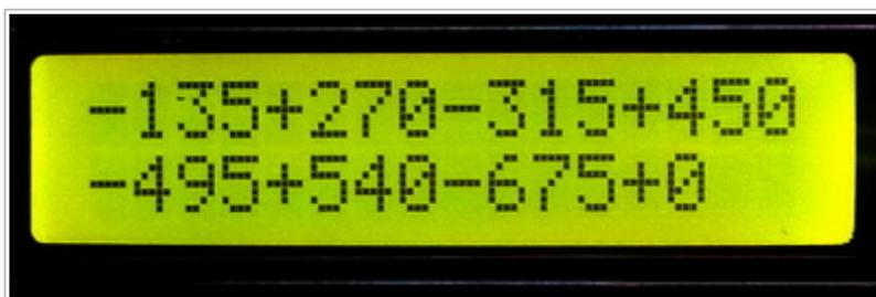
**-135** означает, что на угле  $135^\circ$  сигнал датчика распредвала должен иметь низкий уровень
